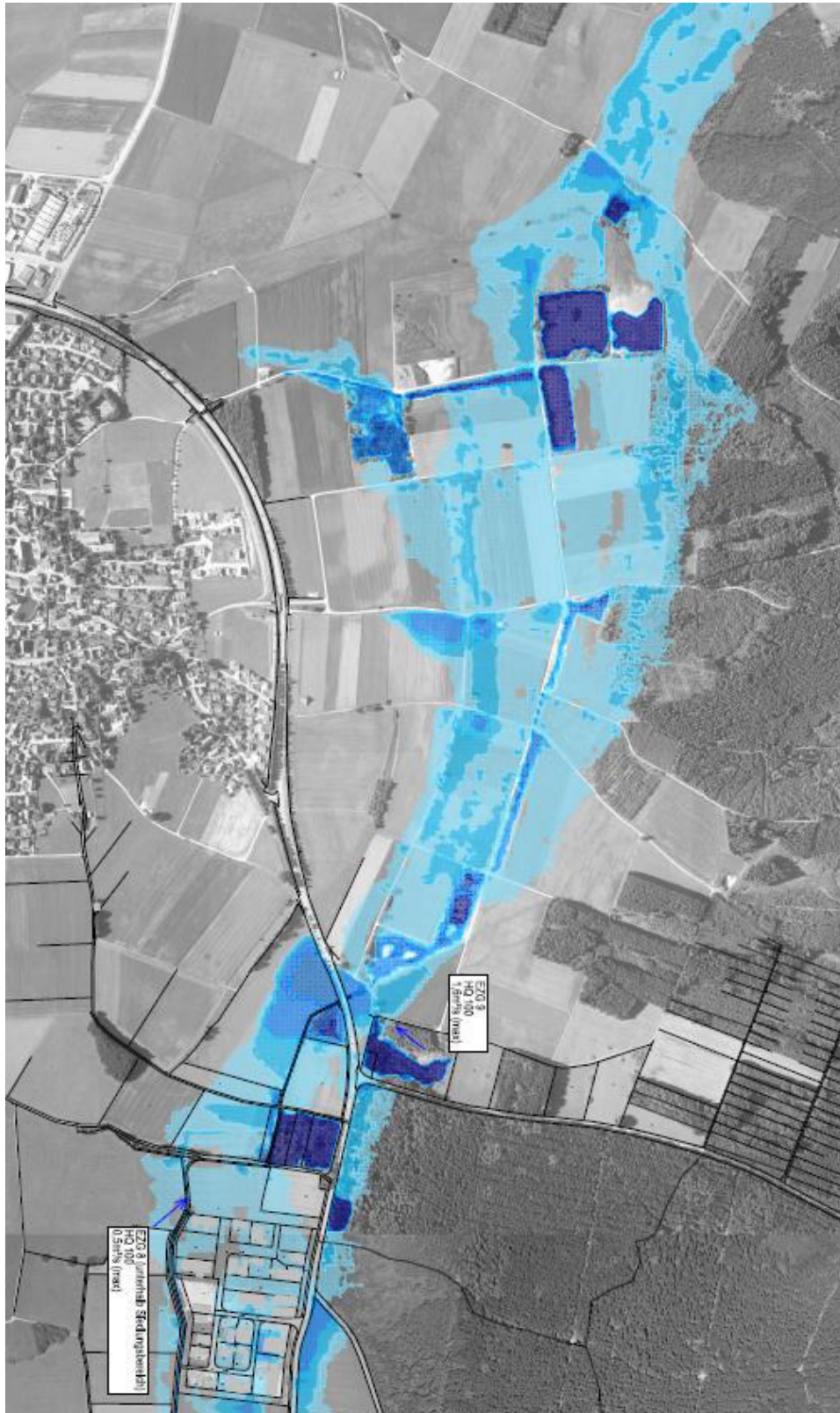
Abbildung 13: HQ100-Ist-Überschwemmungssituation unterhalb von Lengelfeld (instationärer Rechenlauf mit Berücksichtigung der Außengebietszuflüsse).
